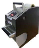
Macchina Termosaldatrice da banco, pannello di controllo con programmazione digitale di temperatura e tempo di saldatura multiformato, possibilità di saldare 6 diversi formati di contenitori senza cambio stampo tramite cassetto interno rotante con selettore mobile (P1-P2-G-H) con Bobina B1, cassetto esterno con selettore mobile (G-L-M) con Bobina B2.
