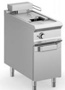
Friggitrice elettrica, 1 vasca da 18 lt, su armadio chiuso. Riscaldamento diretto tramite tubi in vasca. Il sistema di scarico olio a fine servizio è semplice e sicuro con vasca raccogli-olio con filtro in acciaio inox, in dotazione. Tutti i modelli sono dotati di termostato di sicurezza e regolazione termostatica della temperatura dell'olio per mantenere la temperatura dell'olio entro parametri di sicurezza.
