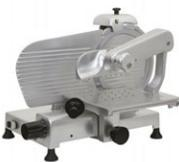
Affettatrice verticale, basamento in alluminio fuso con ossidazione anodica lucida. Coprilama e piatto in alluminio fuso con ossidazione anodica lucida. Albero portalama montato su doppio cuscinetto a sfere. Motore professionale ventilato. Lama mm 300 professionale, temperata, rettificata e cromata a cromo duro. Spessore di taglio fino a 15 mm. Con piatto salumi.
