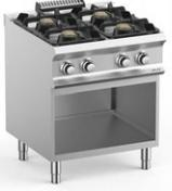
Cucina a gas su vano aperto. 4 fuochi con bruciatori Flex Burner, dotati di sparti-fiamma in ottone a fiamma auto-stabilizzante, per cucinare in sicurezza e per una più facile manutenzione. Ogni bruciatore ha un range di potenza modulabile da un minimo di 1,5 kW a un massimo di 5,5 / 7 kW, per ottenere massima flessibilità. La disposizione dei bruciatori permette l'utilizzo di pentole fino a 40 cm di diametro. Griglie posategami lavabili in lavastoviglie.
