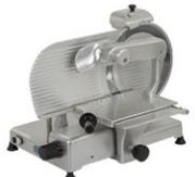
Affettatrice verticale, basamento in alluminio fuso con ossidazione anodica lucida di nuova concezione con spigoli arrotondati. Coprilama e piatto in alluminio fuso con ossidazione anodica lucida. Albero portalama montato su doppio cuscinetto a sfere. Motore professionale ventilato. Lama professionale di terza generazione 100 Cr6. Spessore di taglio fino a 22 mm. Con piatto salumi.
