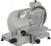
Affettatrice verticale, basamento in alluminio fuso con ossidazione anodica lucida di nuova concezione con spigoli arrotondati. Coprilama e piatto in alluminio fuso con ossidazione anodica lucida. Albero portalama montato su doppio cuscinetto a sfere. Motore professionale ventilato. Lama mm 370 professionale di terza generazione 100 Cr6. Spessore di taglio fino a 22 mm. Con piatto salumi.
