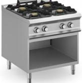
Cucina a gas su vano aperto. 4 fuochi con bruciatori Flex Burner, dotati di sparti-fiamma in ottone a fiamma auto-stabilizzante, per cucinare in sicurezza e per una più facile manutenzione. 2 bruciatori da 7 kW e 2 da 11 kW. La disposizione dei bruciatori permette l'utilizzo di pentole fino a 40 cm di diametro. Griglie posategami lavabili in lavastoviglie.
