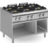
Cucina a gas su vano aperto. 6 fuochi con bruciatori Flex Burner, dotati di sparti-fiamma in ottone a fiamma auto-stabilizzante, per cucinare in sicurezza e per una più facile manutenzione. 3 bruciatori da 7 kW e 3 da 11 kW. La disposizione dei bruciatori permette l'utilizzo di pentole fino a 40 cm di diametro. Griglie posategami lavabili in lavastoviglie.
